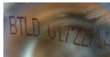
Низкая адгезия чернил — частично смазанная маркировка
